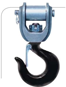
A/B 标准吊钩 铸造钢质吊钩提供持续强度和耐用性。在超负载使用下，吊钩会弯曲打开。标配带有安全锁扣。
